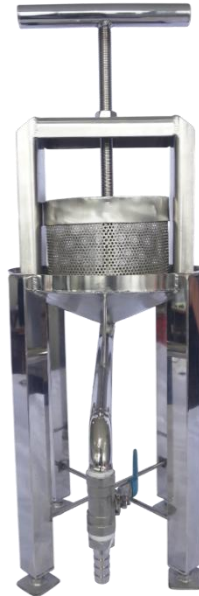
Gambar 4. Realisasi fisik alat ekstraksi madu sistem press manual berbahan stainless steel food grade yang digunakan untuk meningkatkan higienitas proses pascapanen, mengurangi kontak langsung dengan madu, dan meningkatkan efisiensi ekstraksi pada KTH Rimba Langgeng.
