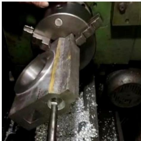
Gambar10. Proses pembuatan rumah bearing dan rumah worm gear menggunakan mesin bubut.
