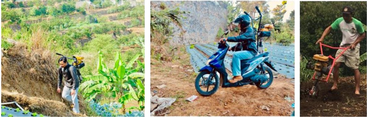
Gambar 1. Traktor digendong, dibawa menggunakan sepeda motor, dan di assembling secara cepat untuk dioperasikan
