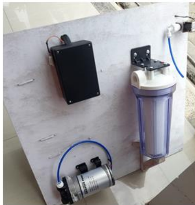
Gambar 4. Gambaran Rancangan Alat Penyemprotan Jamur Otomatis Foto: Dokumentasi Pribadi Diah Risqiwati
